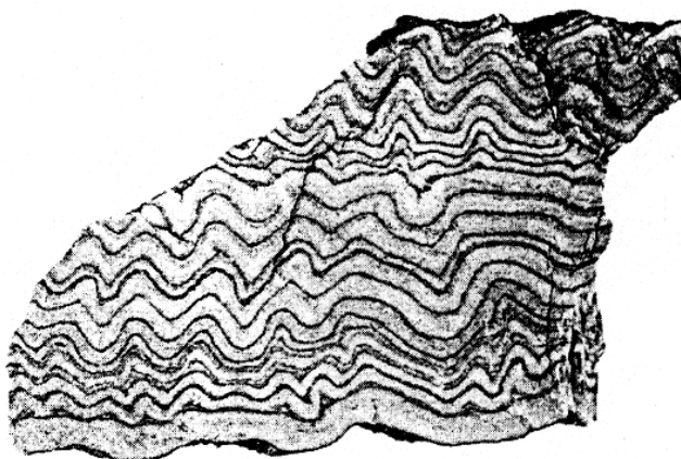
Fig. 24 - Gesso laminado apresentando dobramento enterolítico. Formação Castile (Pérmico), Texas. As películas correspondem a deposições rítmicas anuais. Pettijhon (1975).
