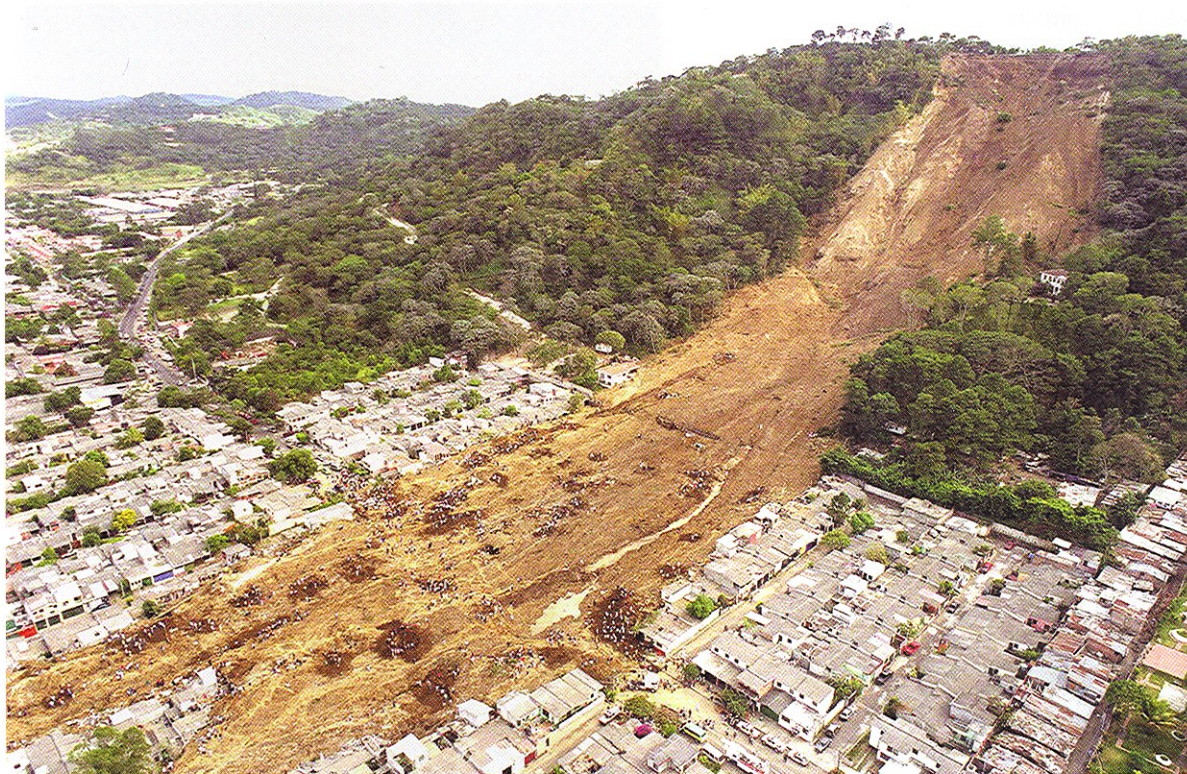
Figura 14.22 Deslizamiento producido por el terremoto de El Salvador el 13 de enero de 2001 en una ladera sobre la Colonia «Las Colinas», municipio de Santa Tecla, Nuevo San Salvador (Agencia EFE). La ladera está formada por un sustrato de tobas sobre el que se apoya un nivel de cenizas volcánicas constituidas por limos arenosos y niveles de lapilli. Estos materiales presentan una densidad aparente entre 1,1 y 1,2 t/m 3 y ángulo de fricción de 34° (Bernal, 2001). Las aceleraciones máximas estimadas en la zona fueron del orden de 0,5 g, lo que provocó el deslizamiento, dando lugar a un flujo muy rápido que sepultó parte de la urbanización. La zona de cabecera del deslizamiento presentó una superficie de rotura circular, con profundidad entre 6 y 8 m, mientras que en el resto el mecanismo fue traslacional. El volumen de la masa deslizada fue de unos 90.000 m 3 .
