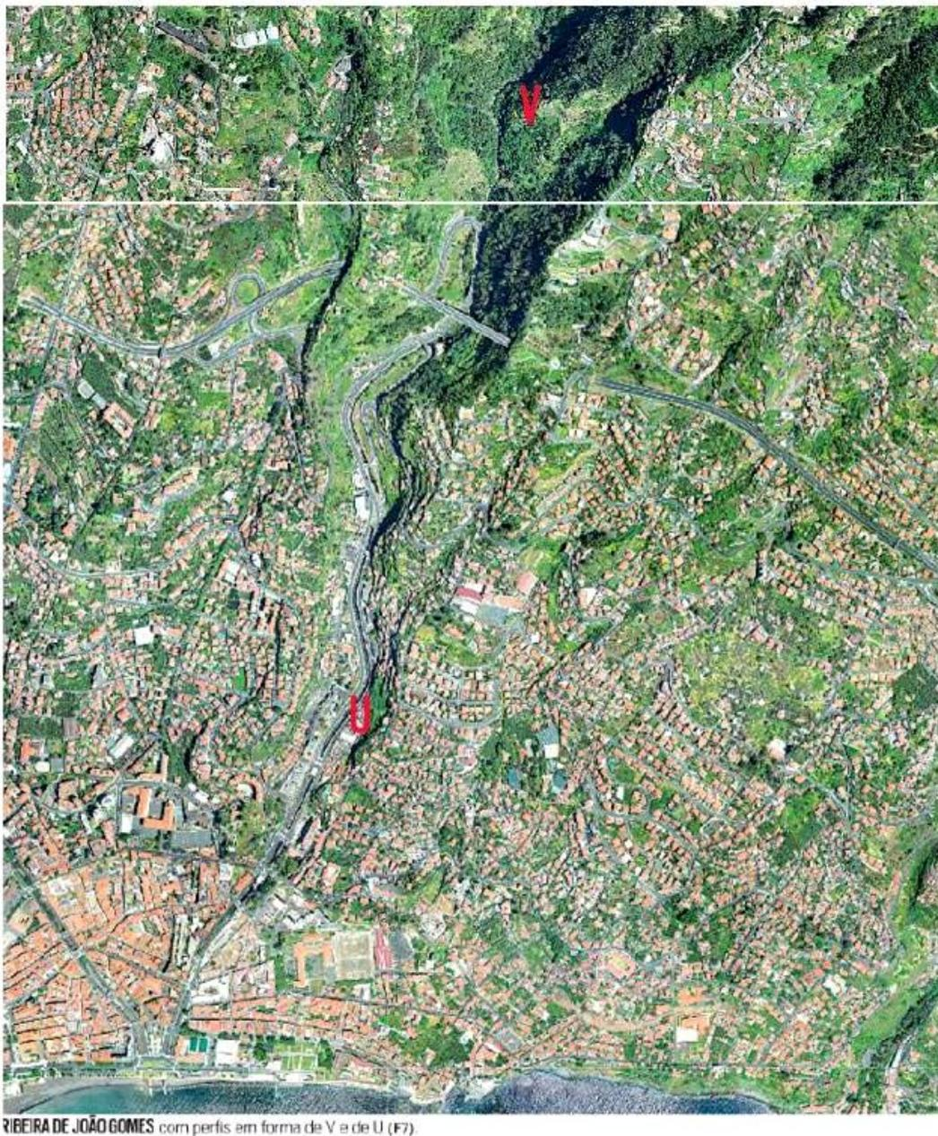
Os diferentes troços que constituem a rede de drenagem de uma bacia hidrográfica podem, e devem, ser ordenados hierarquicamente segundo diversos critérios, o mais frequente dos quais é o utilizado por Strahler. Este modelo consiste na atribuição da ordem 1 aos canais extremos. Da junção de dois canais de ordem 1 origina-se um canal de ordem 2 que se prolonga até encontrar outro canal de ordem 2 de cuja união resulta um canal de ordem imediatamente superior, e assim sucessivamente.
