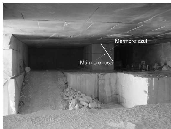
Figura 3 – Limite entre as duas variedades de mármore identificadas num pilar na área de exploração subterrânea da pedreira “Texugo”.
