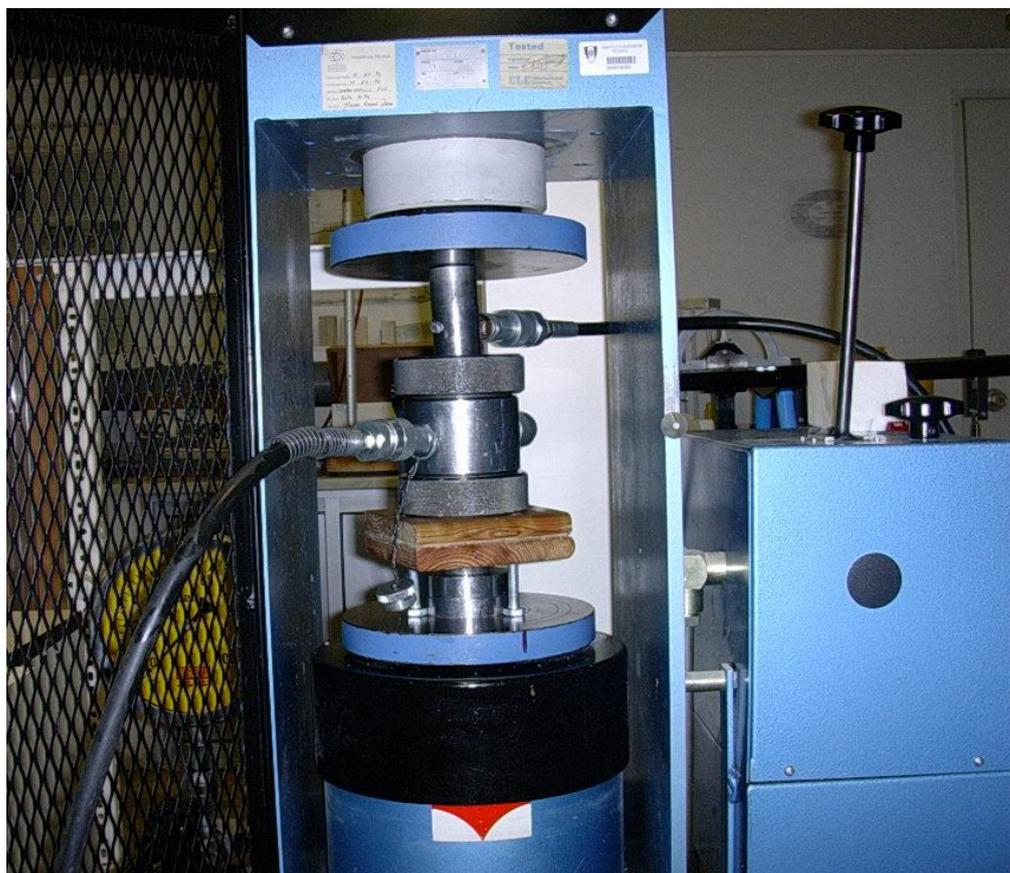
Figura 5 – Câmara triaxial, com provete em ensaio
