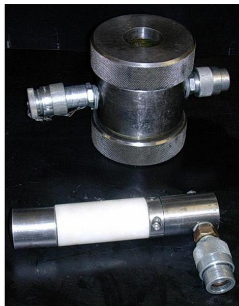
Figura 4 – Câmara triaxial e provete montado
