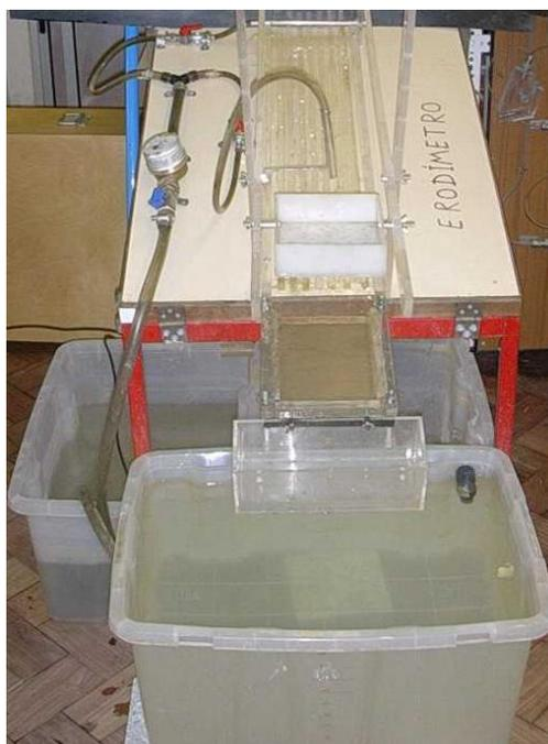
Figura 2 – Provete em ensaio de erodibilidade
