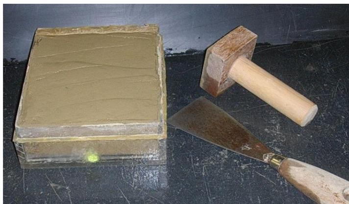
Figura 1 – Preparação do provete para ensaio de erodibilidade
