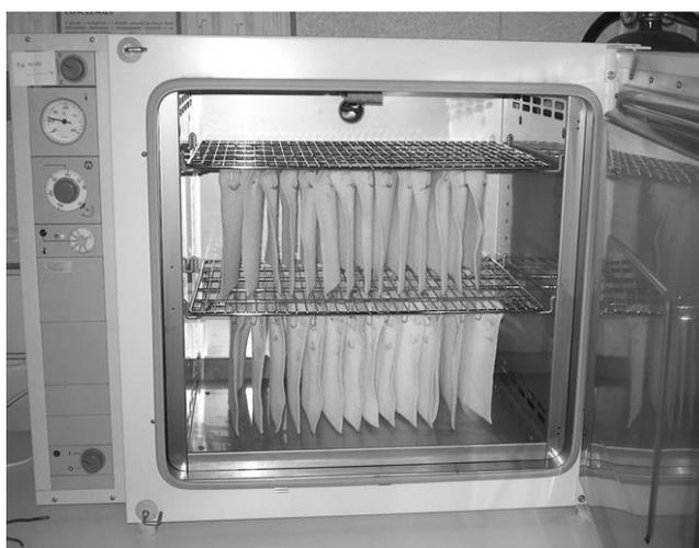
Figura 1 – Ensaio de termo-oxidação
