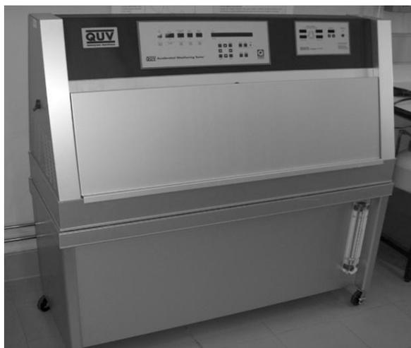
Figura 2 – Simulador climatérico QUV
