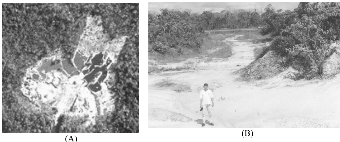
Figura 3 - Área de extração de areia desativada (A); exemplo de jazida desativada devido ao nível de água aflorante (B).
