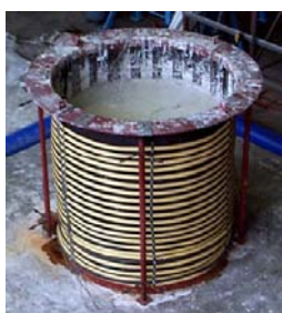
Figura 1 – Reservatório flexível de geometria cilíndrica (adaptado de Riemer e Meymand, 1996)
