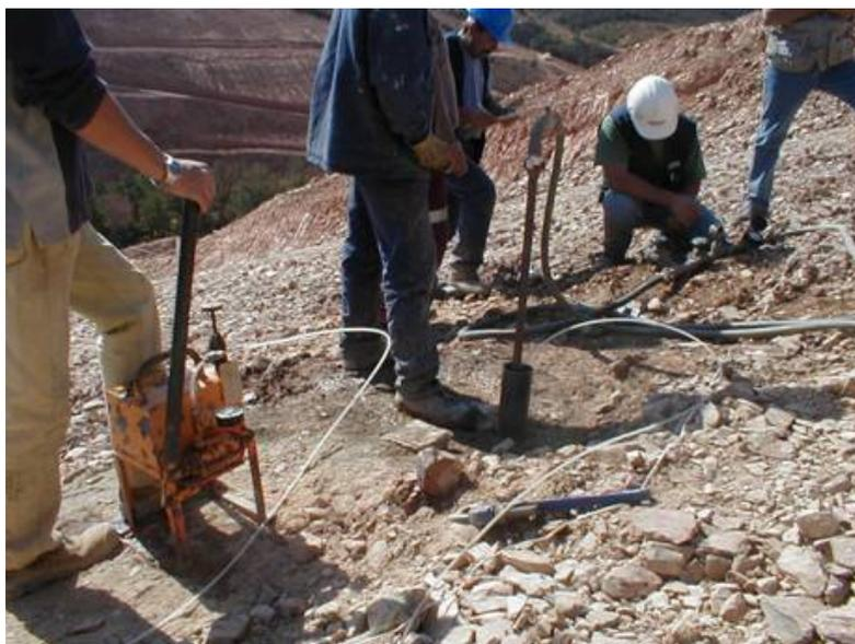
Figura 4 – Aspecto do desenrolar de um ensaio de absorção de água tipo Lugeon, na margem direita.
