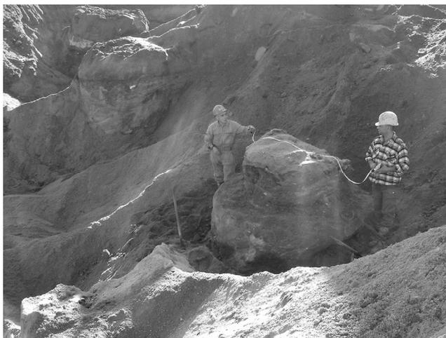
Figura 8 – Colunas de Jet Grouting de teste com diâmetros superiores a 2,0 m.
