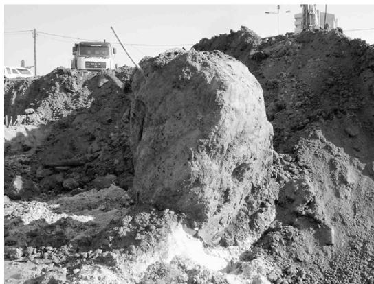
Figura 5 – Coluna de jet grouting de teste ( $\varnothing 1,4\text{m}$ )
