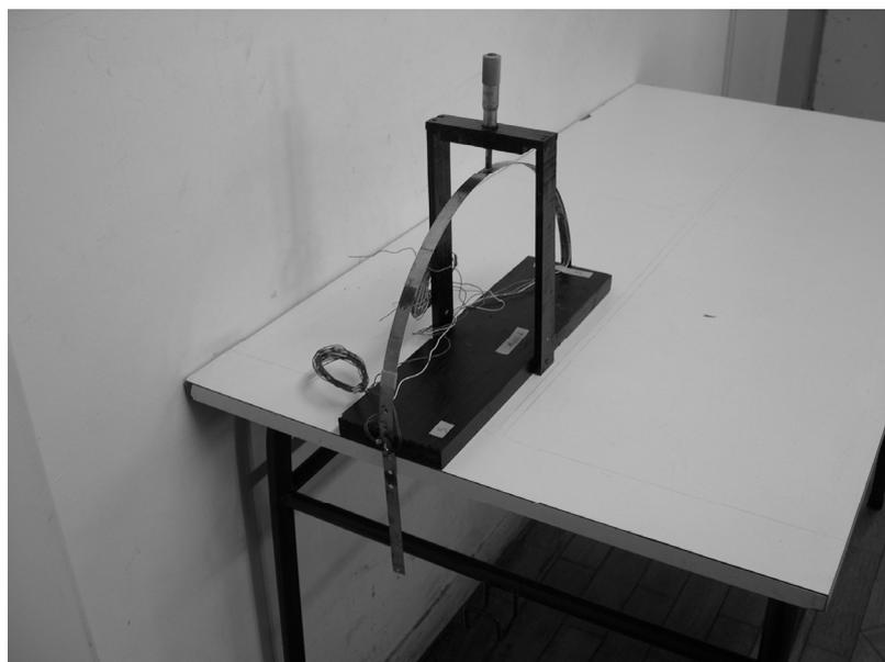
Figura 10 - Modelo laboratorial de cambota com apoio de base deformável
