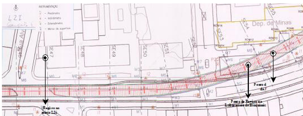
Figura 1 – Locais de registo de vibrações no trecho de obra Alameda - Saldanha
